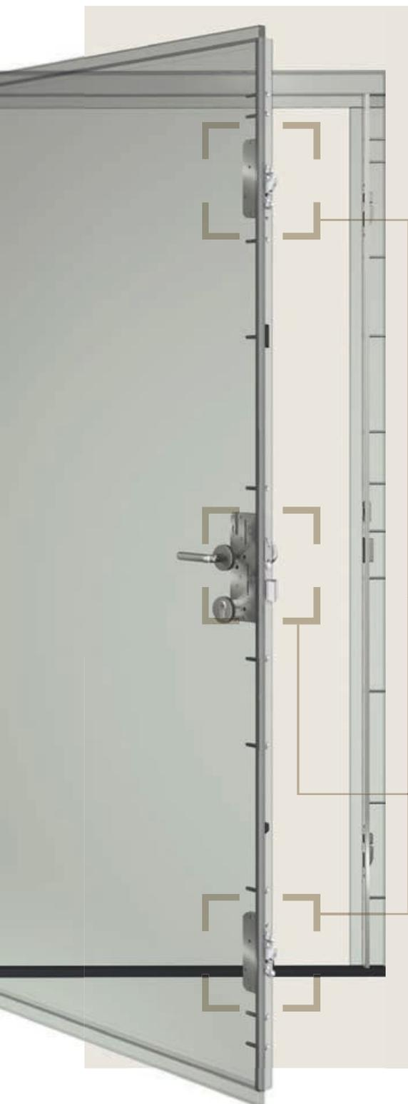
Diese moderne **vollmotorische Variante** verriegelt die Tür vollständig in Sekundenschnelle **an sieben Punkten**. Sobald die Tür ins Schloss fällt, signalisiert ein elektronisches Summen das Ausfahren der **schweren Duobolzen-Schwenkriegelkombinationen** im oberen und unteren Bereich. Betätigen Sie zusätzlich den Schlüssel, so fährt mittig ein weiterer Riegel aus. Dank **integrierter Komfortfunktion** lässt sich die Tür von innen über den Drücker öffnen.
