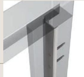
Aus hochwertigem gebürstetem Edelstahl bestehen sowohl Schlosstulp als auch Schließleiste. Beide sind durchgehend auf voller Länge und in U-Form gekantet und in das Holz eingelassen. Diese Variante stabilisiert nicht nur, sie verhindert zuverlässig das Hintergreifen mit Aufhebelwerkzeugen.
