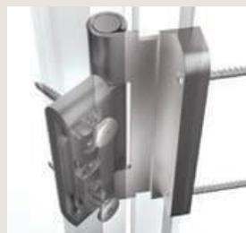
Drei extra schwere dreidimensional verstellbare Bänder tragen 160 kg sicher in der Waagerechten. Leise und sanft schweben die schweren Türflügel geradezu ins Schloss. Einstellarbeiten können ohne Aushängen des Flügels vorgenommen werden.
